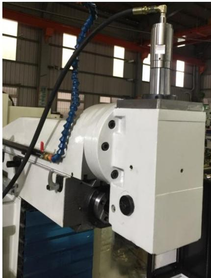
3. LSG-400D Sicherheitsabdeckung für Horizontal-/Vertikalspindelschutz.
